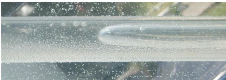
**Fig. 4.1.** Fotografía a 40.5° en el cual se observan algunas características del flujo slug
