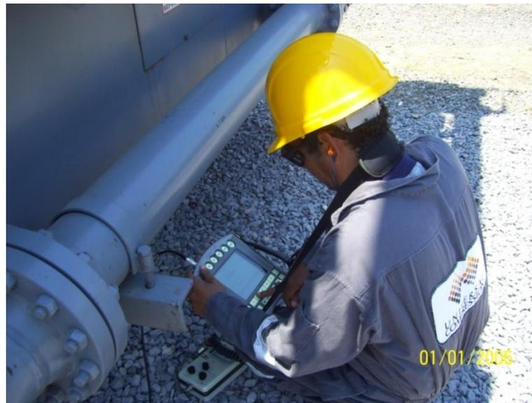
**Figura 8.** Ingeniero recolectando datos de vibración con el equipo para efectuar el análisis correspondiente a la maquina
