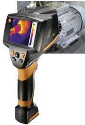
**Figura 9.** Prueba de termografía a un motor
