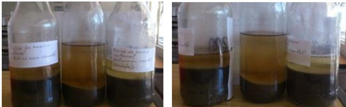
**Figura 1.** Prueba de colorimetría realizada a la arena de “Lagunilla”
