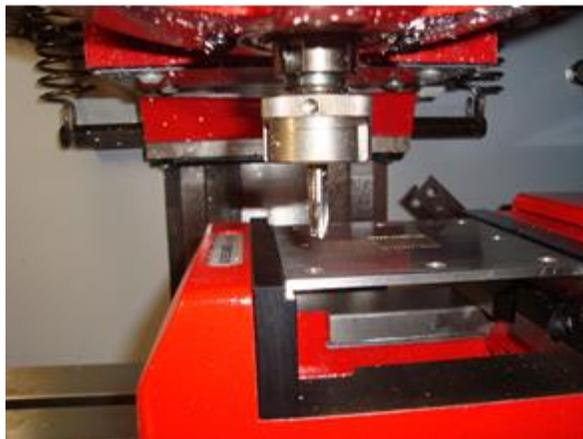
**Figura 5.** Maquinado de los canales en CNC.
