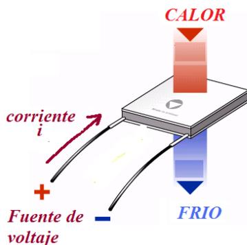
**Figura 2.-** Celda Peltier
