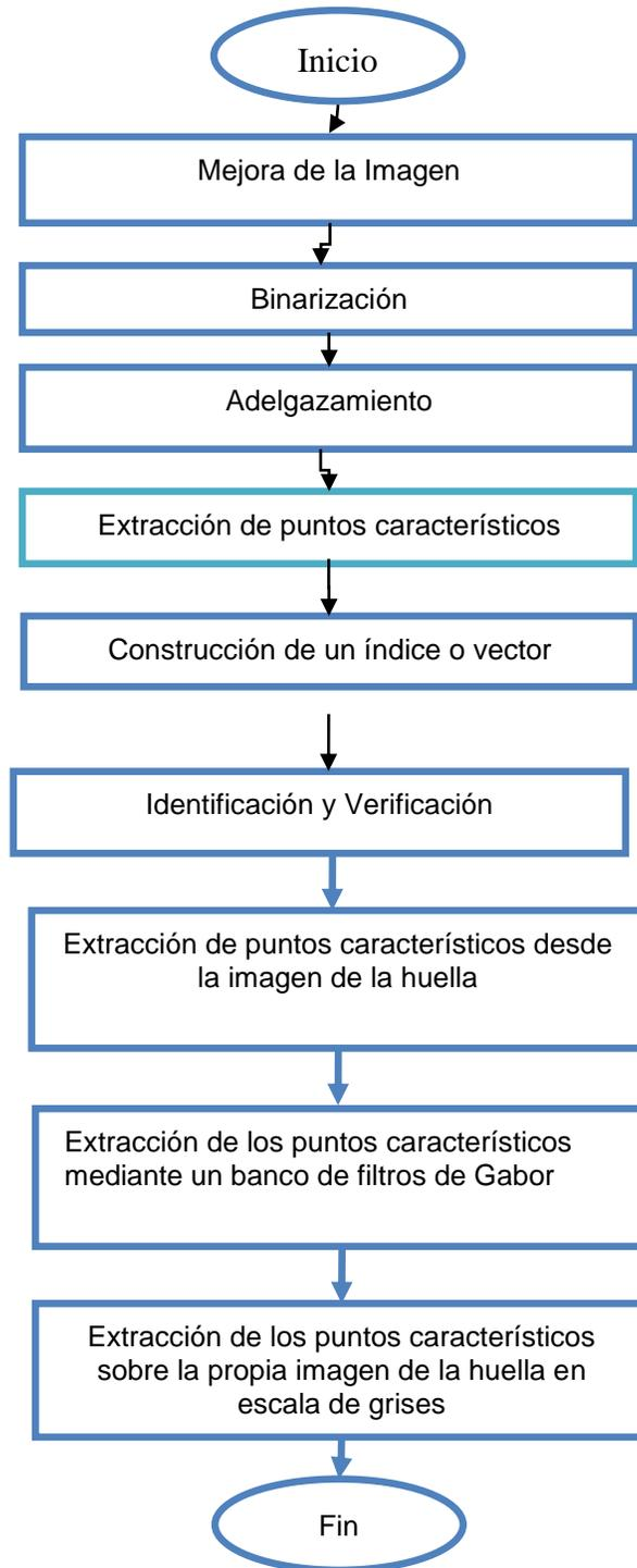
**Fig.10.** Diagrama de procesamiento de la huellas dactilar.
