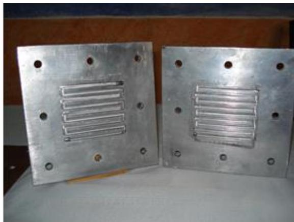
**Figura 9.** Celda de Combustible tipo PEM.
