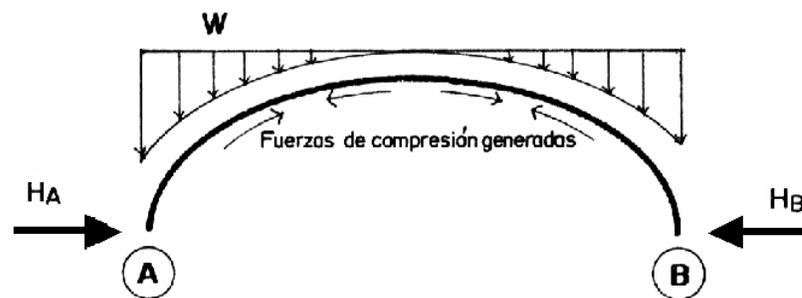
Figura 6.- Aquí podemos constatar el trabajo mecánico de empuje horizontal de la bóveda, equilibrándose entre sí una vez colocada y amacizada con el colado definitivo.
