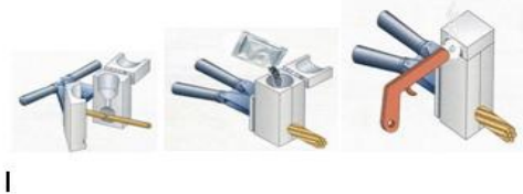
Fig. 7 Método de soldado exotérmico
