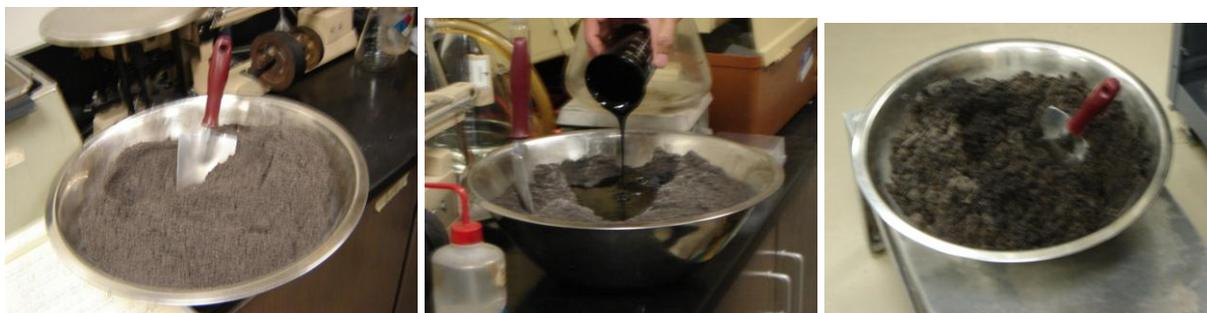
Paso 3. *Figura 2. Mezcla de arena, agua y aceite.* Se mantiene la temperatura constante a lo largo del tubo, posteriormente, se presuriza el tubo (usando valores conocidos del yacimiento antes de comenzar la ignición).
