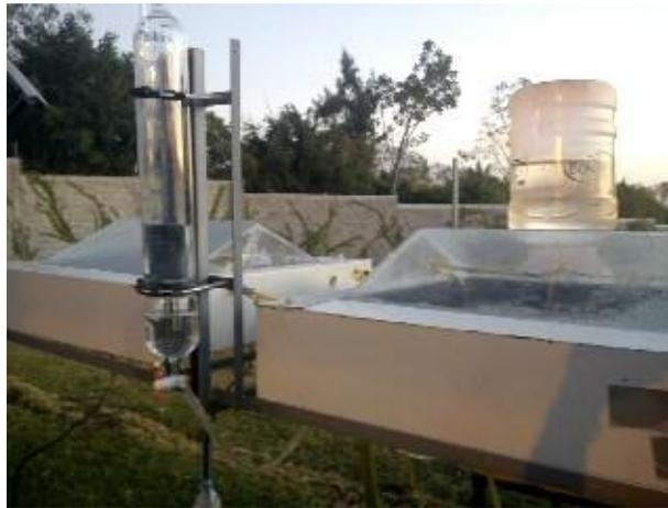
Figura 1. Destiladores solares de agua de doble caída en operación instrumentados con termopares tipo K.
