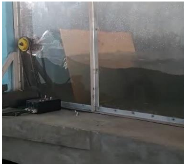
Figura 6. Prototipo generador de la ola.
