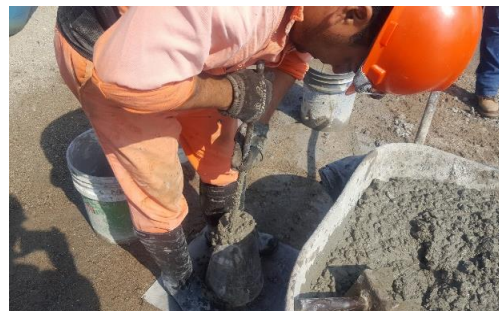
Figura 13 y 14. Llegada de concreto y prueba de revenimiento al mismo.
