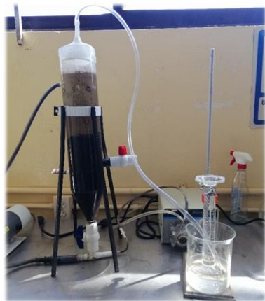
Figura 2. Reactor FFA en operación por lotes.
