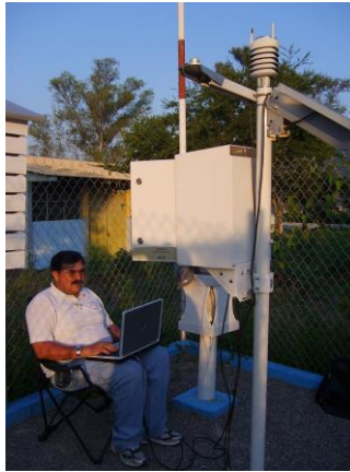
Figura 1.- Estación meteorológica automática.
