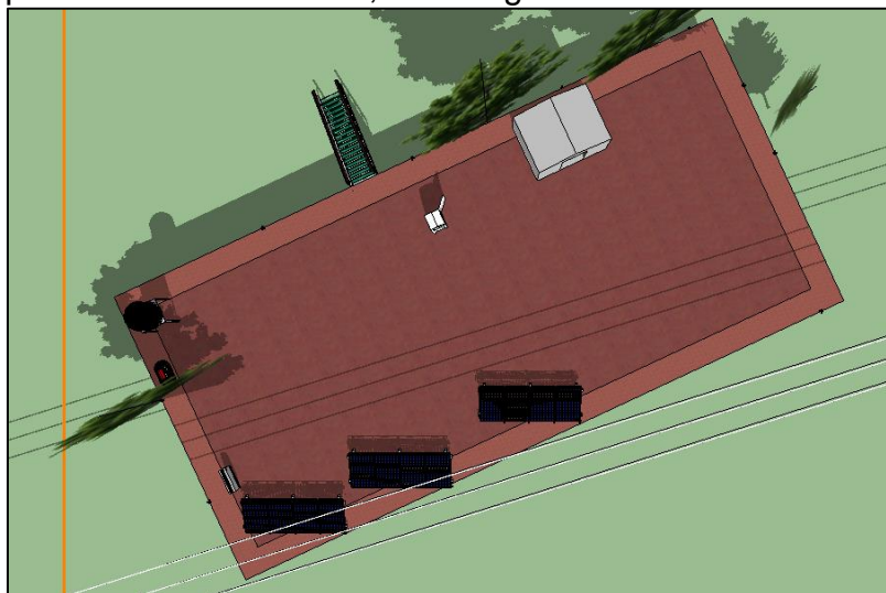
Figura 5.- Modelación del efecto de sombreado.
