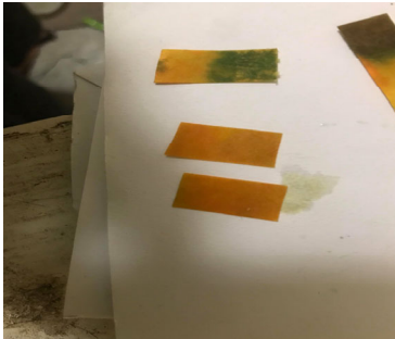
Figura 13 Pruebas por tiempo de proceso de electrolysis (2 min, 30 segundos y 20 segundos).
