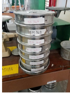
Figura 7. “Recipientes con números diferentes de mallas para obtener agregado fino”.
