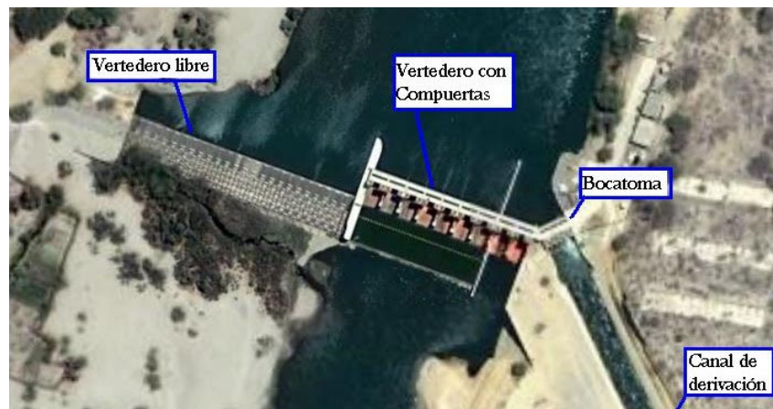
Figura 1.- Ejemplo de las partes de una presa derivadora
