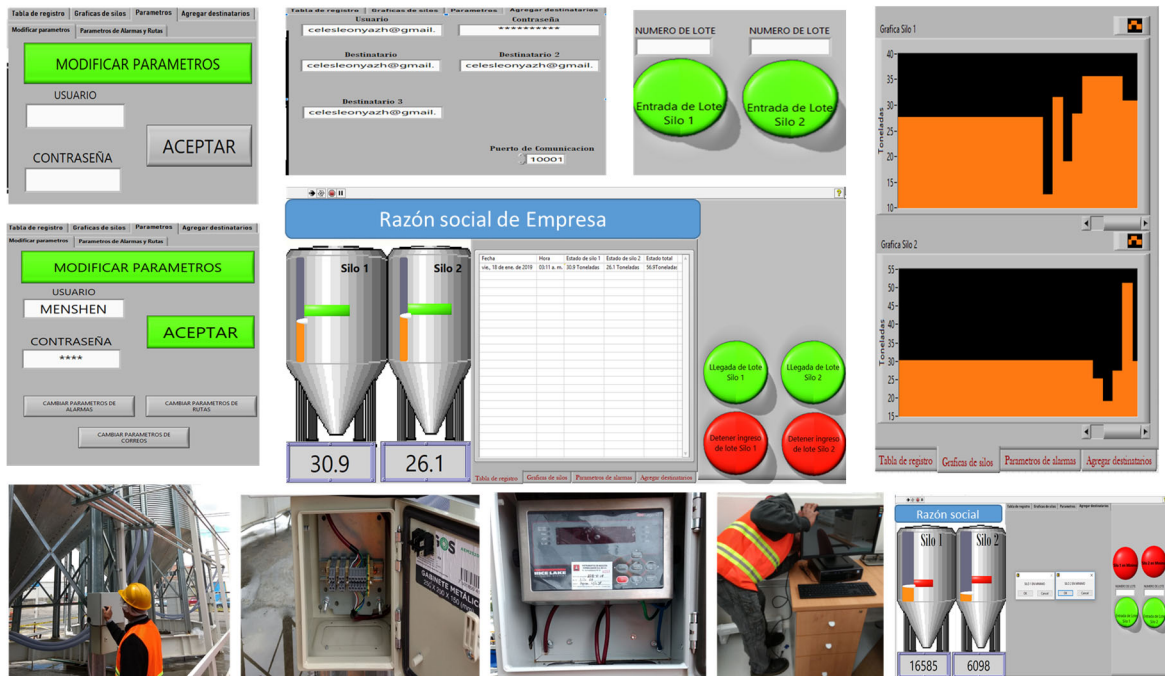
Figura 7.- Diseño e Integración de Interfaz Gráfica (HMI) basada en Labview para el monitoreo y control de proceso e inventarios de silos
