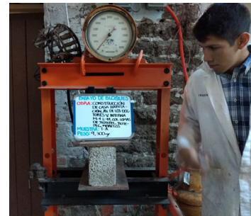
Figura 14.- Ensayo de block a compresión
