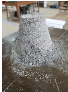
Figura 6. “La muestra después de haber retirado el molde troncocónico”
