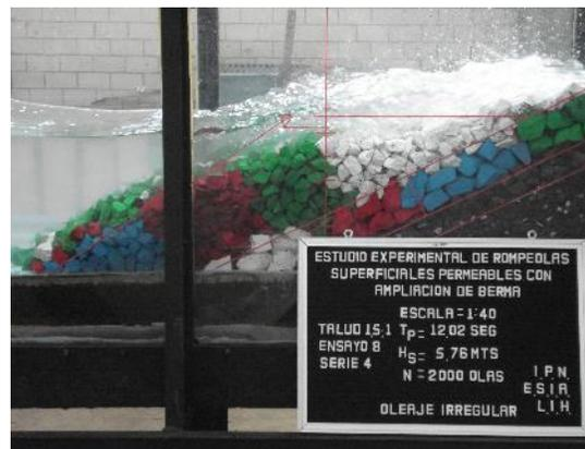
**Figura 7.-** Ensayo 12 Tercera berma con talud 1.5:1, Tp = 12.02 segundos y Hs = 5.76 metros. 12.000 olas acumuladas.
