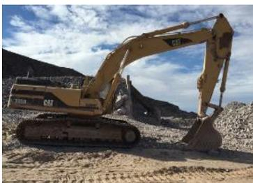
**Figura 8.-** Excavadora Caterpillar 345-B. Utilizada para remover el material y cargarlo al equipo de transportación.
