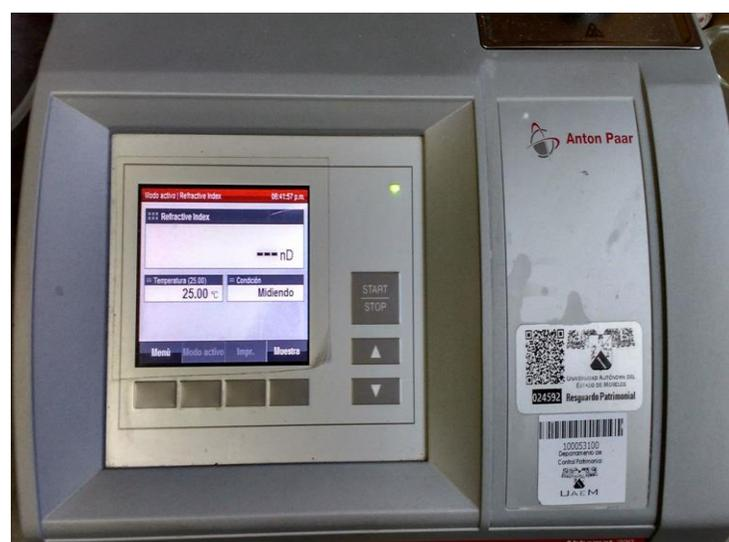
Figura 3.- Refractómetro Anton Paar Abbemat 200
