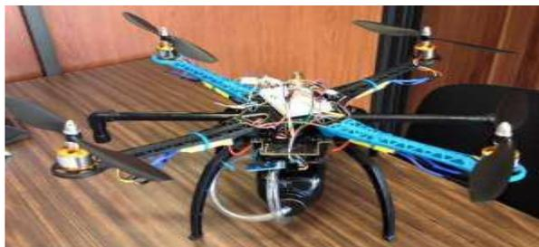
**Figura 14.-** Drone terminado listo para ser programado.
