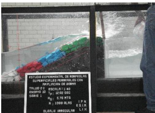
Al final de los ensayos para esta primera estructura el ascenso máximo rebasa por completo la corona de la estructura. Se observó que la mayoría de las olas rebasaban la misma. Se presentaron desplazamientos de algunas rocas de las diferentes franjas del rompeolas tipo (capa de coraza). (Figura 3).
