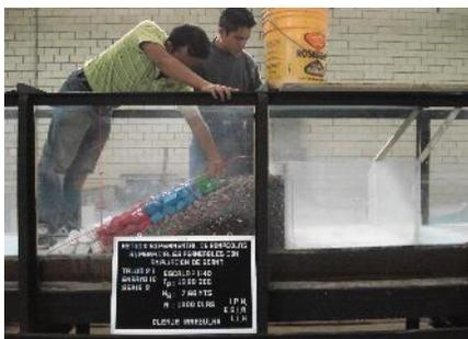
**Figura 2.** Colocación de las diferentes capas del rompeolas tipo.
