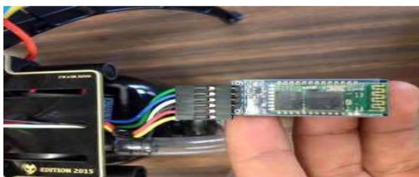
**Figura 11.-** Conexión del Bluetooth.
