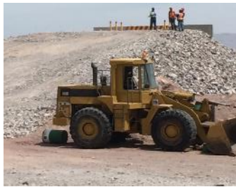
Figura 9.- Cargador frontal 966-F. Transporta el material hacia la zona de carga y la rezaga hacia la zona no utilizable.
