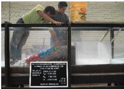
Figura 2. Colocación de las diferentes capas del rompeolas tipo.
