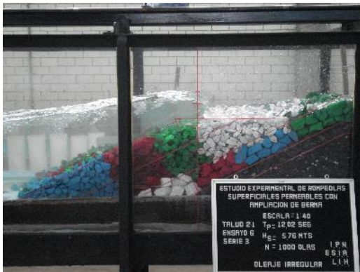
Figura 5.- Ensayo 10. Segunda berma con talud 2:1, T_p = 12.02 segundos y H_s = 5.76 metros. 10,000 olas acumuladas.
