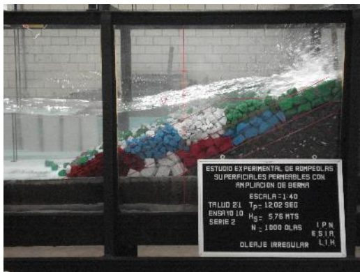
Figura 4.- Ensayo 10. Primera berma con talud 2:1; T_p = 12.02 segundos y H_s = 5.76 metros. 10,000 olas acumuladas.
