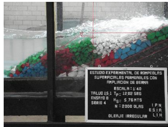
Figura 7.- Ensayo 12 Tercera berma con talud 1.5:1, T_p = 12.02 segundos y H_s = 5.76 metros. 12.000 olas acumuladas.
