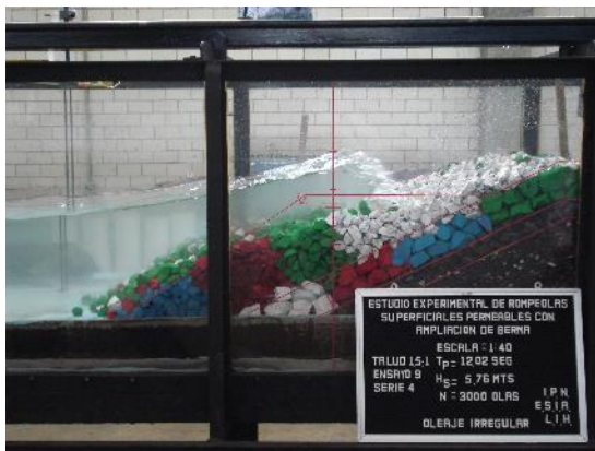
Figura 6.- Ensayo 11. Tercera berma con talud 1.5:1, T_p = 12.02 segundos y H_s = 5.76 metros. 11,000 olas acumuladas.
