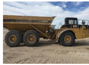
Figura 10.- Camión articulado 350-D. Transporta el material hacia la zona de cribado, y la rezaga hacia la zona no utilizable.
