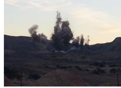
Figura 7.- Ejemplo de detonación para la obtención de los materiales.
