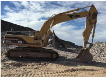
Figura 8.- Excavadora Caterpillar 345-B. Utilizada para remover el material y cargarlo al equipo de transportación.
