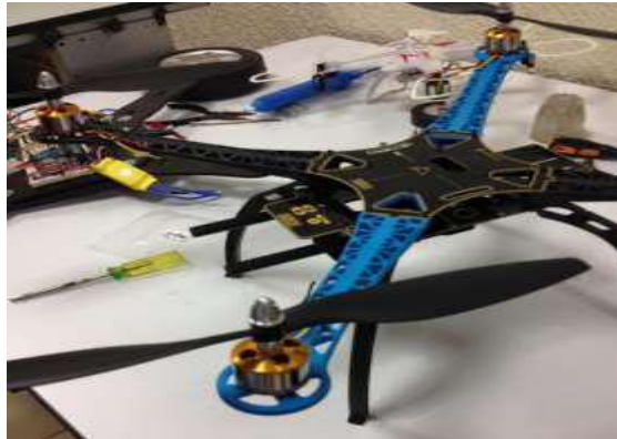
Figura 5.- Montaje de las hélices a los ejes de cada uno de los motores
